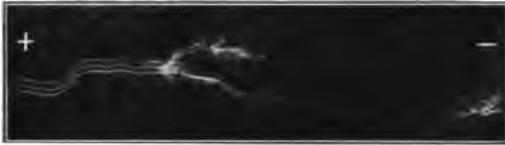
Abb. 348. Vorentladungen ohne vollständigen Übergang.
